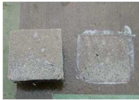
破断面にレイタンス
