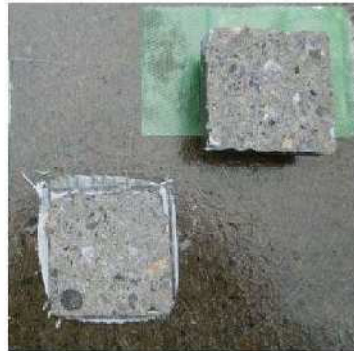
破断面にレイタンスなし
